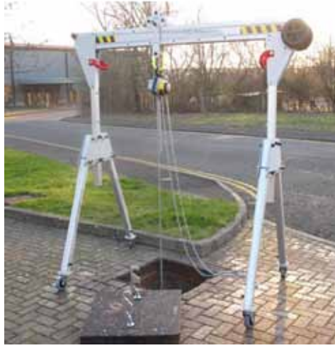
Kurtarma vinci opsiyonlu portal vinç, çalışma sahasından emniyetli mesafede kurtarma operasyonu sağlar.
